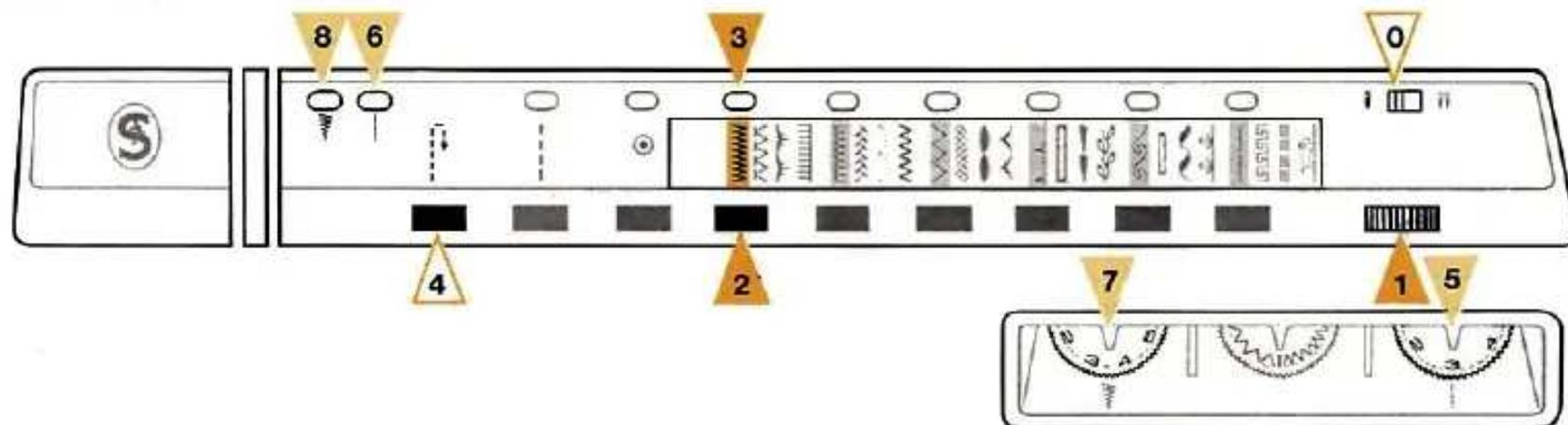
S'assurer que l'interrupteur 0 est sur la position gauche symbolisée par l'aiguille simple (
